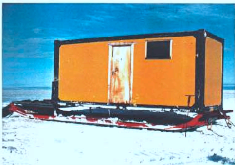
'n Vraghouer was op 'n slee geplaas en ingerig as werkswinkel
