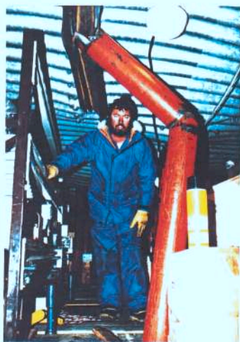
'n Staalstut in die voorradestoor wat onder die drukking gekruik het
