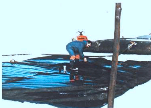
Die gebreekte 50 000 lt dieseltank nadat 'n naat losgeskeur het
