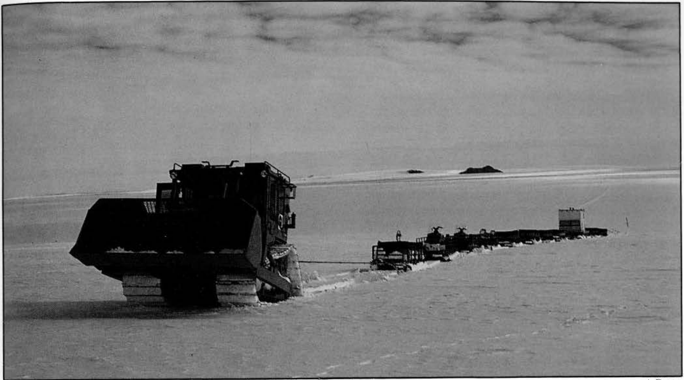
'n D6 kruiptrekker word gebruik om skidoos en brandstof oor lang afstande te vervoer
